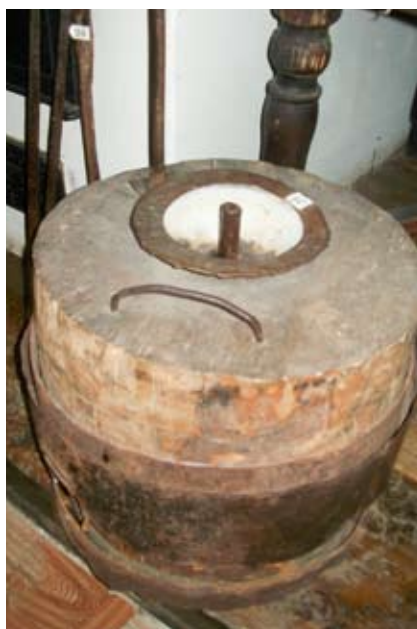
Мельница ручная. XIX в. Ручная работа. Дерево, железо,ковка. Изготовил житель Михайловска рабочий И. Пухов.
